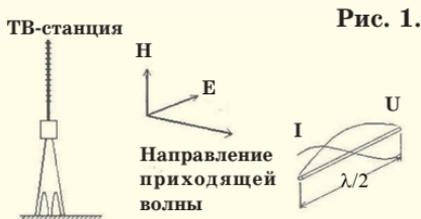
На рисунке 1 упрощенно показано, как наводится напряжение в диполе от передатчика телевизионной станции.
